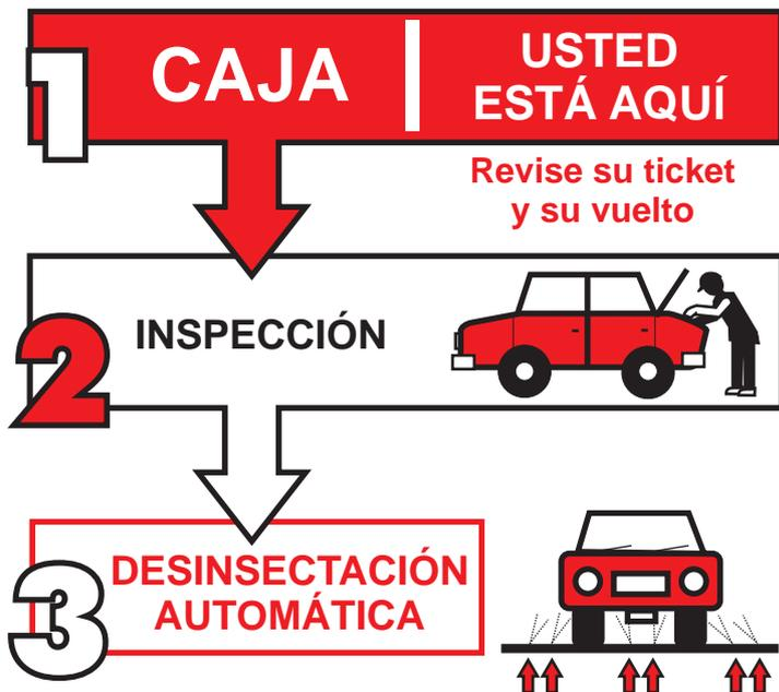
La desinsectación de vehículos se realiza con un sistema automático que pulveriza una solución con insecticida (Cipermetrina 25%), por medio de picos que se ubican a nivel del piso. La toxicidad del insecticida utilizado es prácticamente nula para los animales de sangre caliente, siendo alta para los insectos (Ej.: mosca de los frutos).
